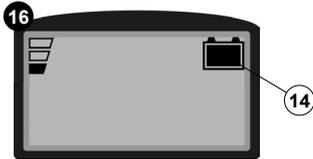
На панели управления машины находится дисплей. В верхней центральной части дисплея имеется графический символ (14) индикатора уровня зарядки батарей (рис. 16). Индикатор состоит из 5 различных уровней заряда, каждый из них означает примерно 20% оставшегося заряда. Когда батарея разряжена до 20%, графический символ начнет мигать, и через несколько секунд выключается. В этом случае необходимо отвести машину в место, используемое для зарядки батарей.
