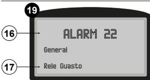
При обнаружении ошибки на дисплее управления открывается страница аварийных сигналов с символом на ней (рис. 19).
